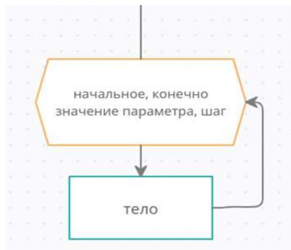
Рис. 58. Блок-схема цикла с параметром
