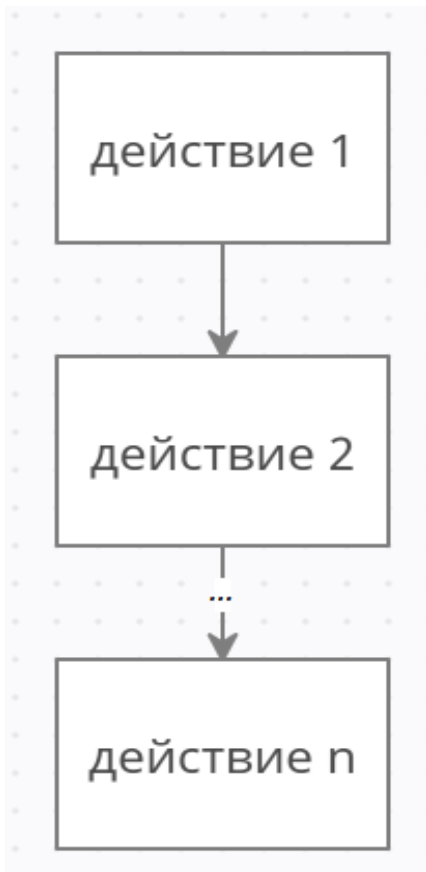
Рис. 107. Блок-схема линейного алгоритма
